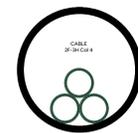
Cálculo ocupación de tubería de cable 2+1, calibre 4 en tubería de 2"  $\phi$
