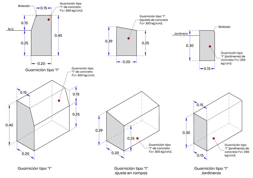
01 Detalle Guarnición tipo "I" Esc. 1:10
